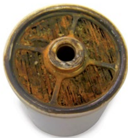
Filtro sin mantenimiento
